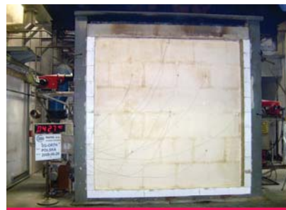
Fot. 2. Widok ściany próbnej po upływie 4 godz. 27 minut od rozpoczęcia badań
